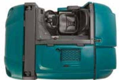
Excelentes resultados en diferentes superficies gracias a cepillos laterales dobles que, combinados con una caja colectora Duramer™ grande de 395 litros, permite un ancho de barrido de hasta 2.030 mm en una simple pasada.
